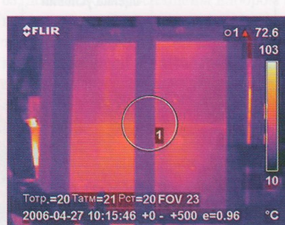
Рис. 2. Термограмма боковой поверхности миксера
